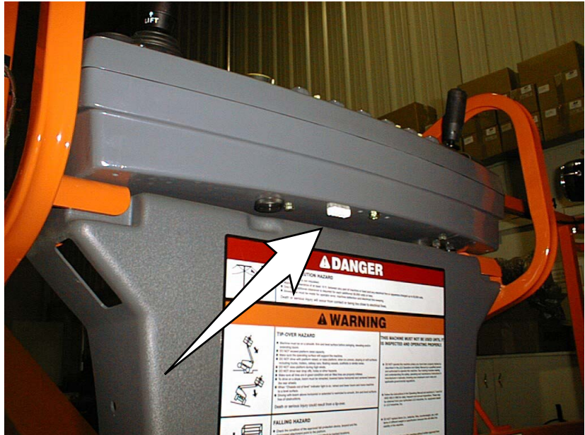
CONEXIÓN DE LA PLATAFORMA
