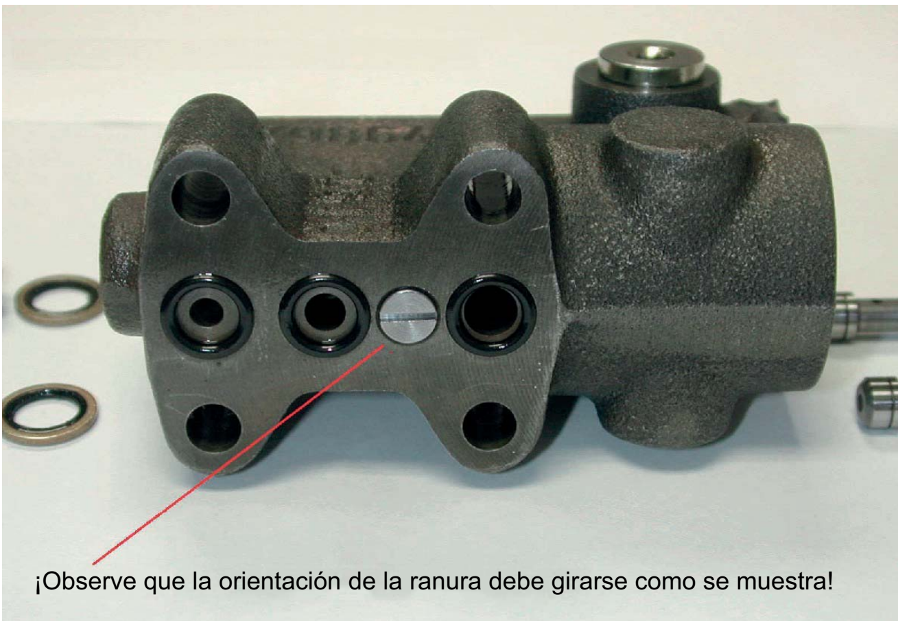
Figura 5-34. Bomba de función, control del flujo y la presión – Hoja 3
