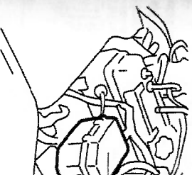
(1) Caja de fusibles
